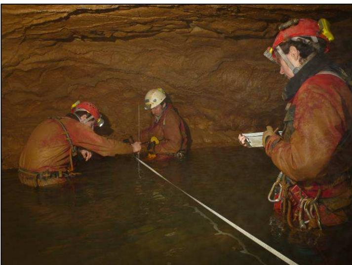
Figure 5 : exemple de relevé de section (ici siphon amont cascade)
